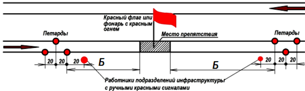
Схема ограждения внезапно возникшего препятствия на двухпутном участке.
