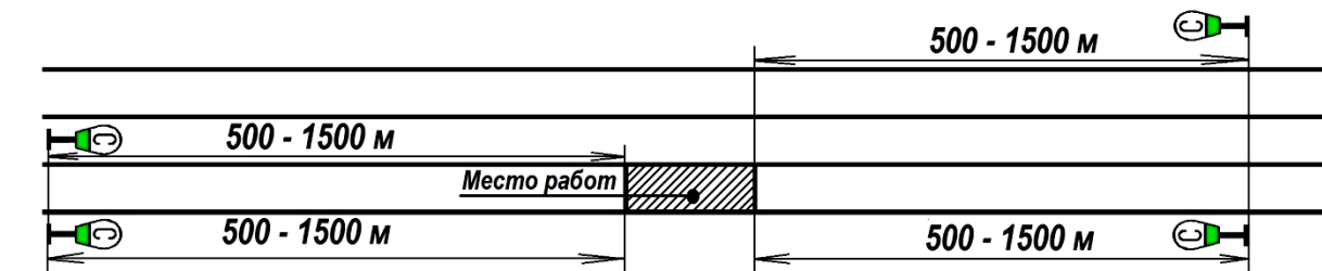
Схема ограждения места работ, не требующего остановки и уменьшения скорости, на перегоне на крайнем пути трехпутного участка при скоростях движения поездов до 120 км/ч.
