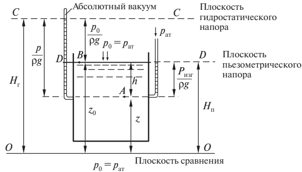
Рис. 1.16. Сосуд с жидкостью под атмосферным давлением
