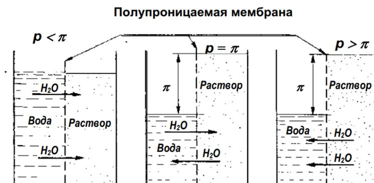
Рис. 1 Схема разделения раствора обратным осмосом
