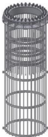
Рисунок 8- Общий вид арматурного каркаса буронабивной сваи
