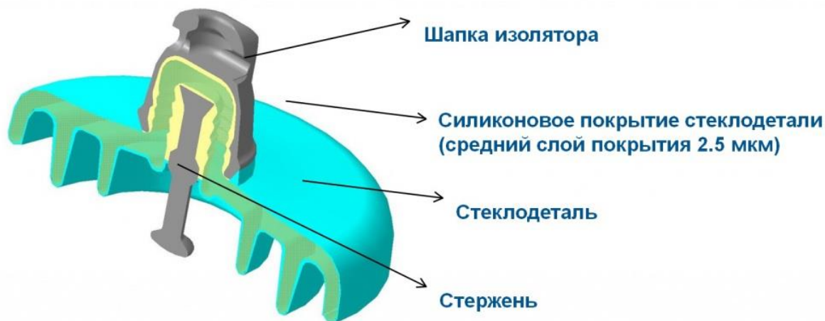
Рисунок 30- Конструкция изолятора с силиконовым покрытием
