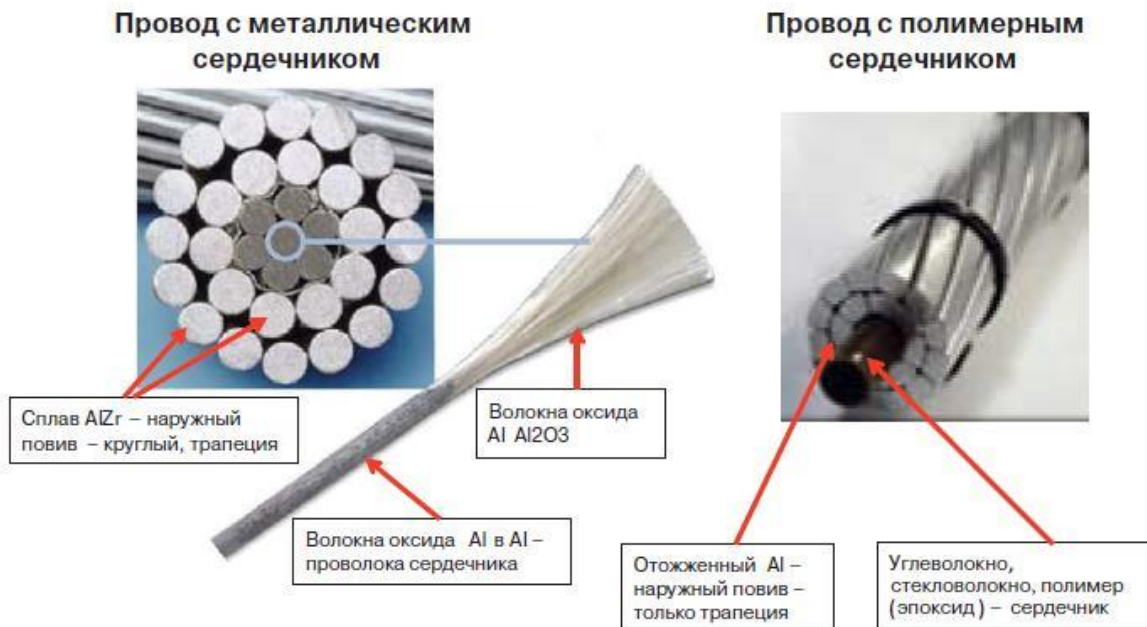
Рисунок 25- Общий вид и конструктивные особенности провода ACCR
