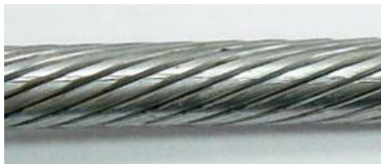
Рисунок 27- Общий вид и конструктивные особенности МЗ-В-ОЖ-Н-Р
